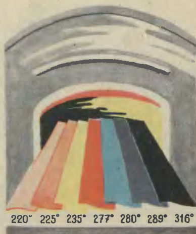
Цвета побежалости на стали, возникающие при различной температуре нагрева.
